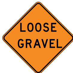
W8-7* LOOSE GRAVEL
